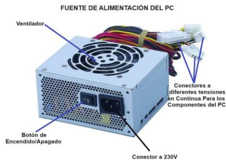
Imagen 6 Fuente de alimentación de energía
