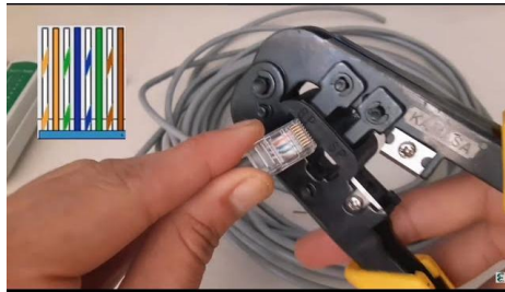
Imagen 33 Ponchado de cables Rj45
