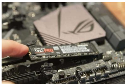
Imagen 14 Instalar las unidades de almacenamiento
