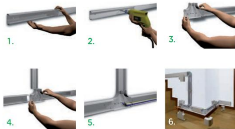
Imagen 32 Instalación de canaletas
