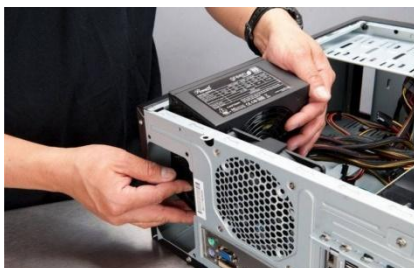
Imagen 10 Instalar la fuente de alimentación
